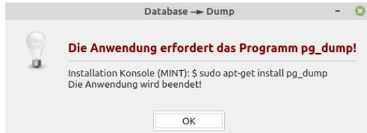
Abbildung 22.12.4: Fehlermeldung: Das Programm `pg_dump` ist nicht installiert
